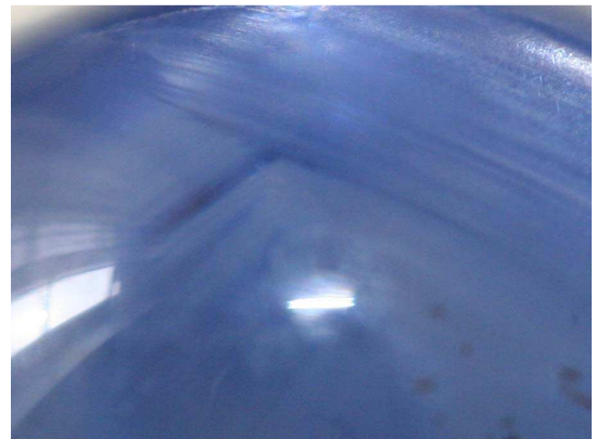
Photo 2 : des chevrons visibles à la loupe x 10 sur un saphir étoilé (122-Sap-b-5)
